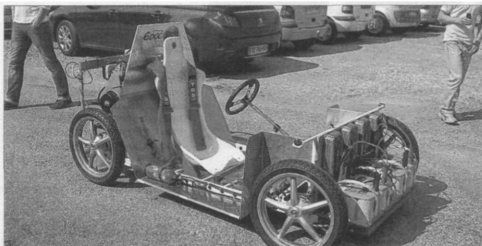
Du 2 au 5 mai, l'entreprise **S3D** participera au challenge Educ'eco dans le Gers avec une voiture équipée d'un moteur diesel alimenté par un biocarburant à base de graisse de confit de canard.
